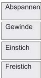
Циклы канавок для форм Е и F (CYCLE94), а также для резьбовых канавок форм А до D (CYCLE96) объединены в программной клавише "Канавка".
